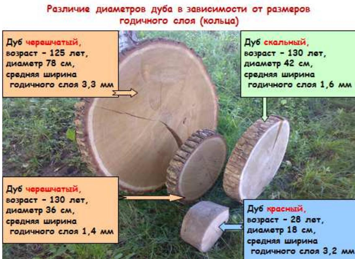
Рис.4. Поперечные срезы клепочного кряжа различного назначения
