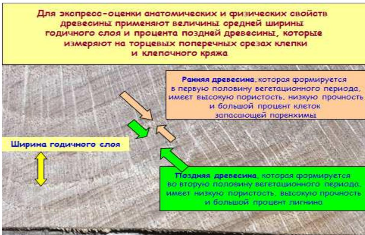
Рис. 3. Распределение ширины годичного слоя на раннюю и позднюю древесину
