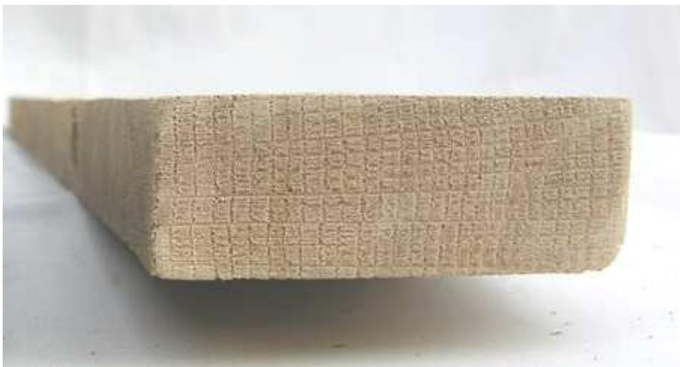
Рис. 1. Клепка радиального вида распиливания для производства бочек
