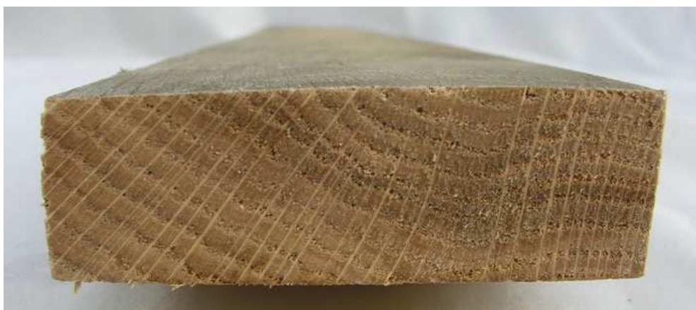
Рис. 2. Клепка тангенциального вида распиливания для закладки в крупные резервуары
