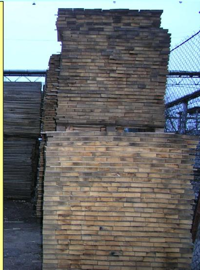
11. Выход высококачественной клепки, отобранной по требованиям западноевропейского рынка, из типичного отечественного клепочного кряжа, составляет 14-25%. При этом, значительная часть отходов может быть использована в технологических процессах виноделия.
